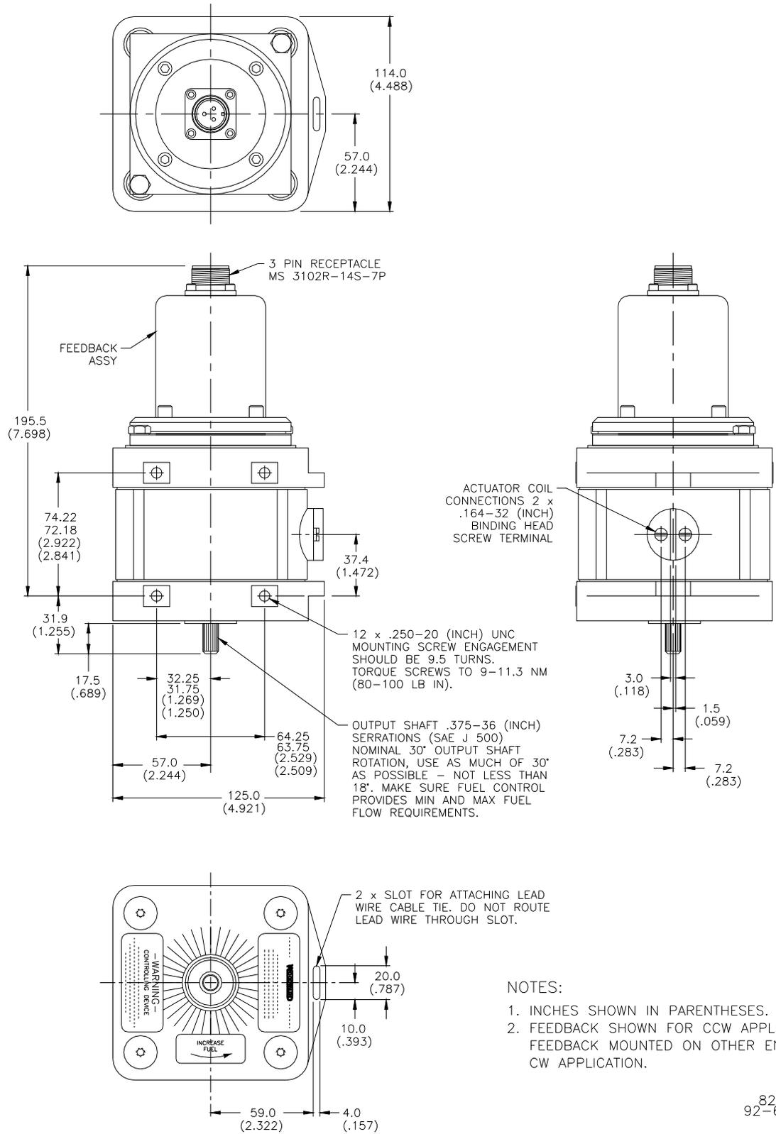
Figure 3-8. 524 Electric Actuator
