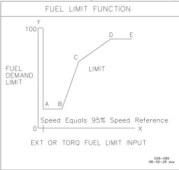
Figure 3-8. Torque Limit Curve
