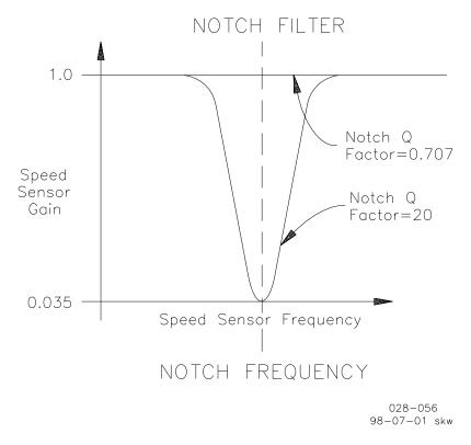
Figure 3-6. Notch Filter
