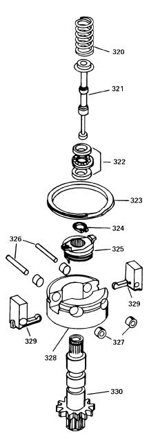
Figure 5-9. Spring-Driven Ballhead Parts
