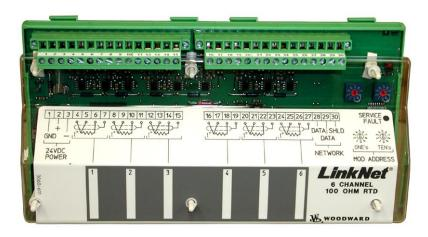
Figure 10-6. LINKnet 6Ch RTD Module
