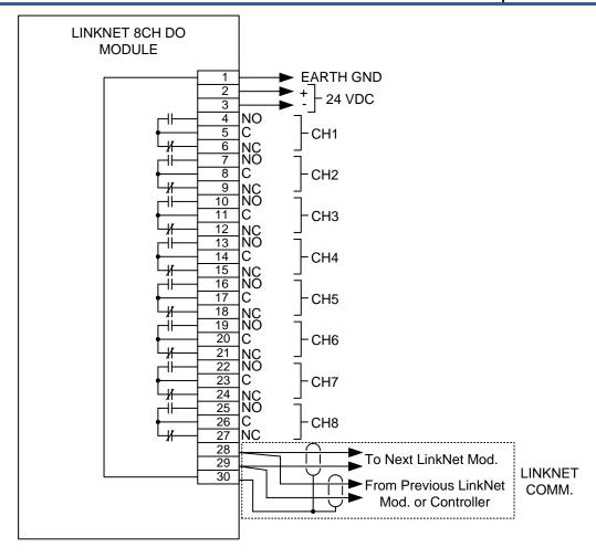
Figure 10-23. LINKnet 8CH DO Module Wiring
