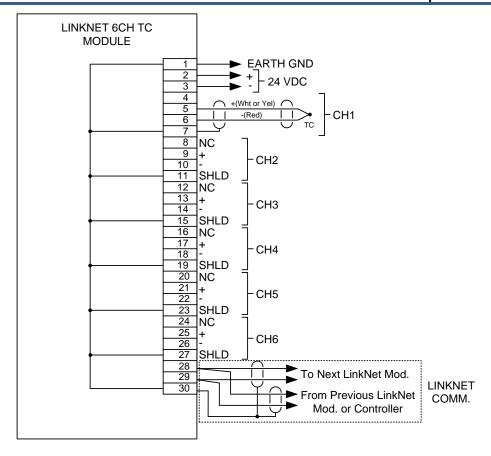
Figure 10-10. LINKnet 6CH TC Module Wiring
