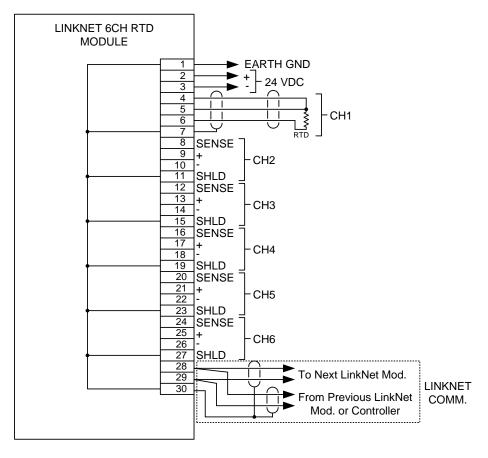
Figure 10-7. LINKnet 6CH RTD Module Wiring
