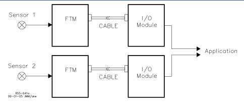
Figure 3-16. Redundant Inputs
