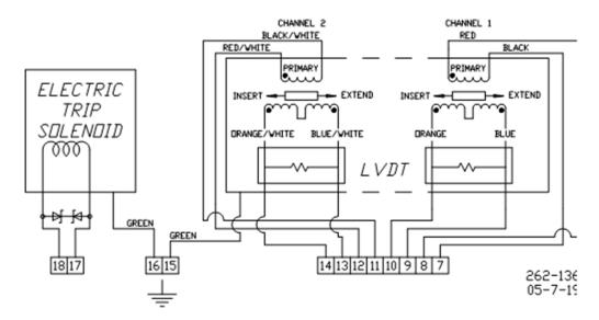
Figure 1-11b. Wiring Diagram – Dual-Entry Conduit Box
