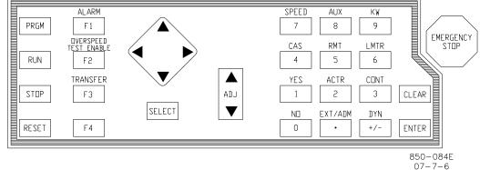
Figure 1-8. 505 Keypad and Display
