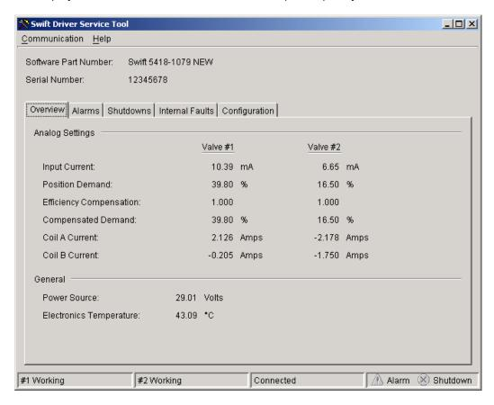
Figure 7-4. Analog Parameters
