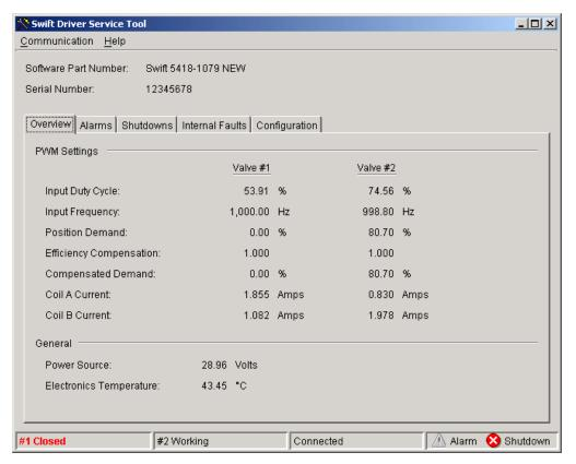
Figure 7-6. PWM Parameters
