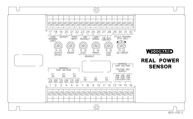
Figure 1-1. Real Power Sensor (8272-781 & 8272-826)
