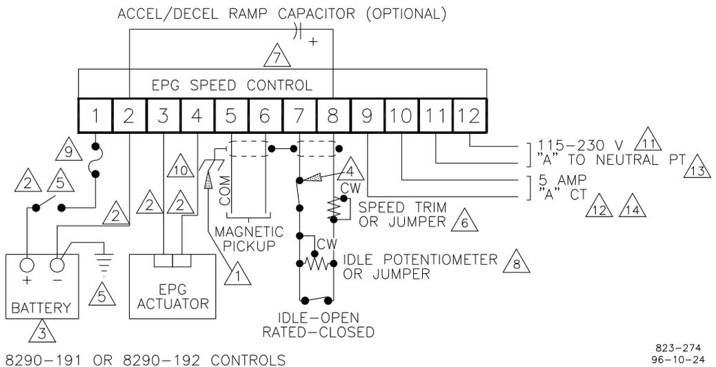
Figure 1-4. Wiring Diagram (EPG Models 8290-191, -192)
