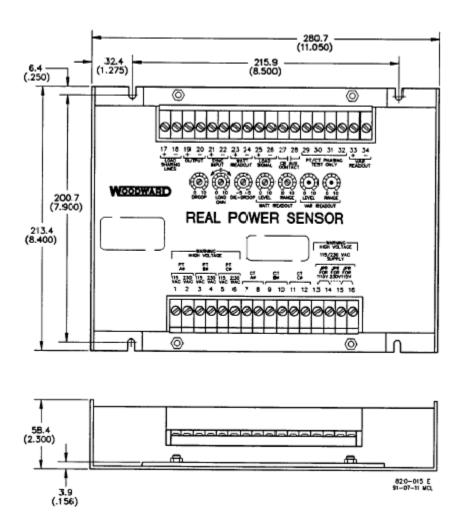
Figure 8-6. Real Power Sensor
