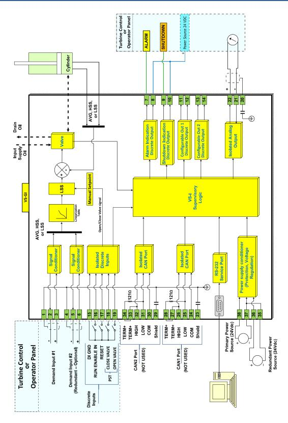
Figure 4-6. VariStroke-TTV Interface Diagram
