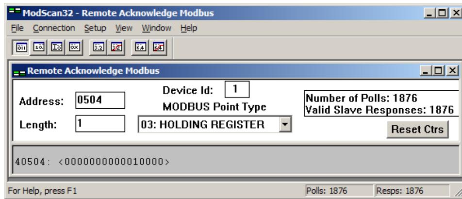
Figure 4-14: Modbus - remote control parameter 503
