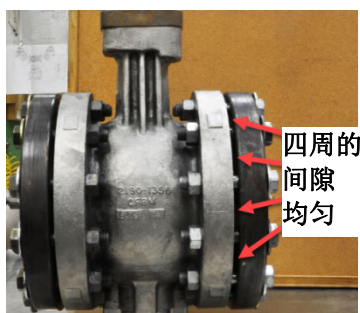
图 2-7. 与法兰之间的间隙均匀
