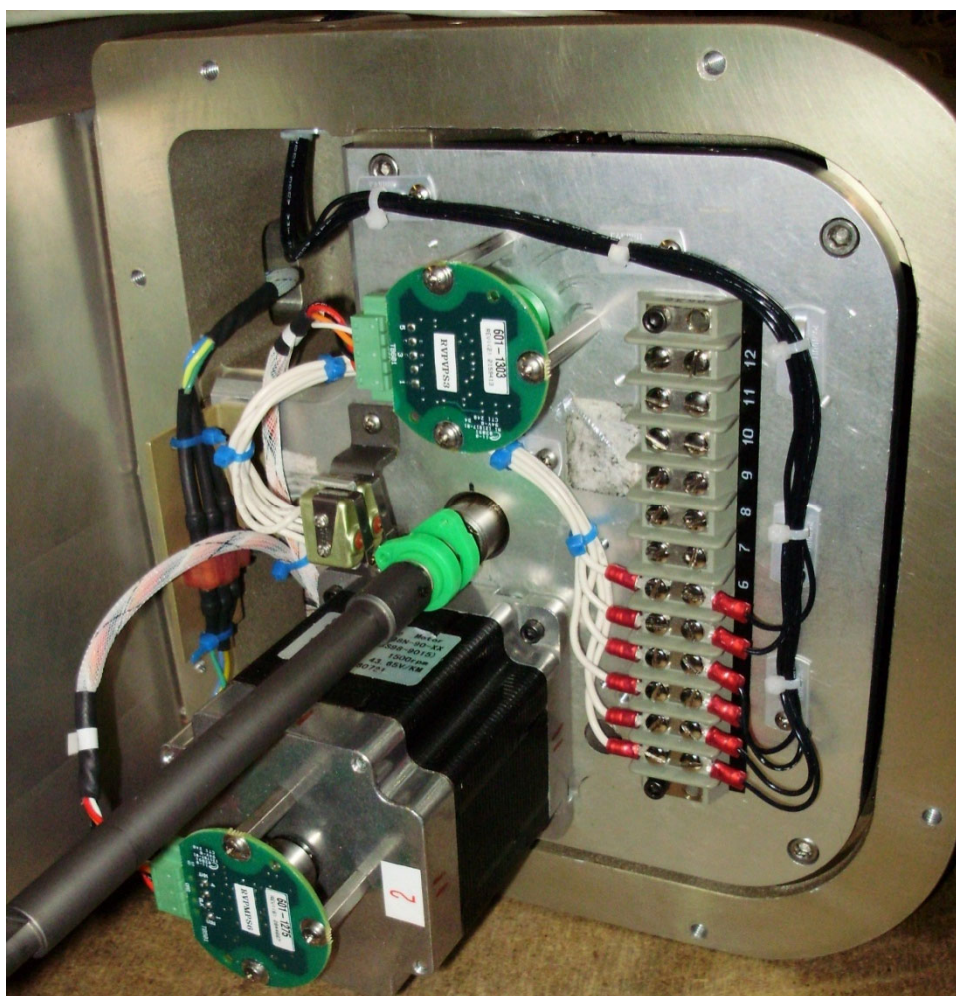
图 2-18. 执行器限位开关电源接口：左上
