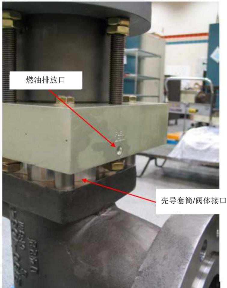
图 4-1a. 3、4 和 6 英寸阀门检查区域
