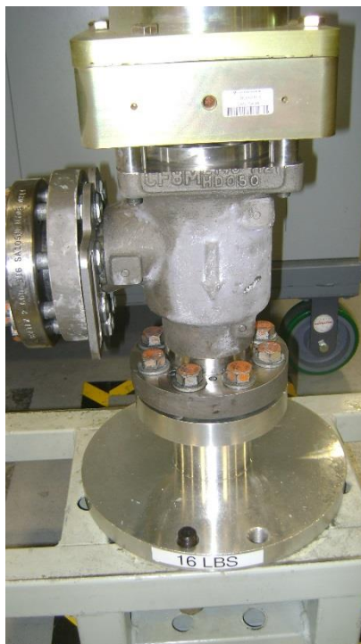
圖 3-6. 以凸緣螺栓支撐出口凸緣
