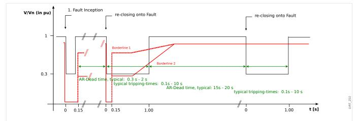
Fig. 78: Run of voltage curve during an unsuccessful two-shot auto reclosure; source: Technische Richtlinie, Erzeugungsanlagen am Mittelspannungsnetz, Ausgabe Juni 2008, BDEW Bundesverband der Energie- und Wasserwirtschaft e.V. (Page 89).
