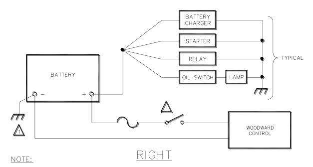
A NEGATIVE GROUND SYSTEM IS SHOWN. IF A POSITIVE GROUND SYSTEM IS USED, THE SWITCH AND FUSE MUST BE LOCATED IN SERIES WITH BATTERY (-) AND TERMINAL (TB1-2) ON THE WOODWARD CONTROL. THE POSITIVE TERMINAL BECOMES CHASSIS GROUND.
