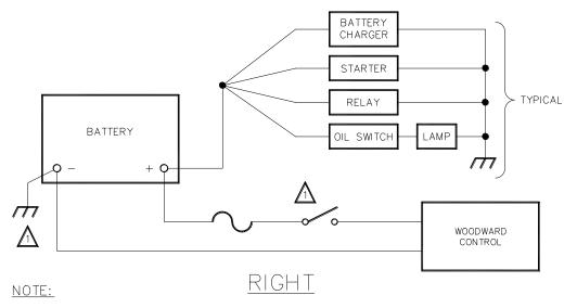
A NEGATIVE GROUND SYSTEM IS SHOWN. IF A POSITIVE GROUND SYSTEM IS USED, THE SWITCH AND FUSE MUST BE LOCATED IN SERIES WITH BATTERY (-) AND INPUT POWER (-) ON THE WOODWARD CONTROL. THE POSITIVE TERMINAL OF THE BATTERY BECOMES CHASSIS GROUND AND IS CONNECTED TO INPUT POWER (+) ON THE WOODWARD CONTROL.
