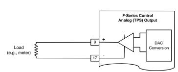
Figure 3-6. Analog (TPS) Output
