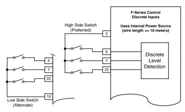
Figure 3-8. Discrete Inputs
