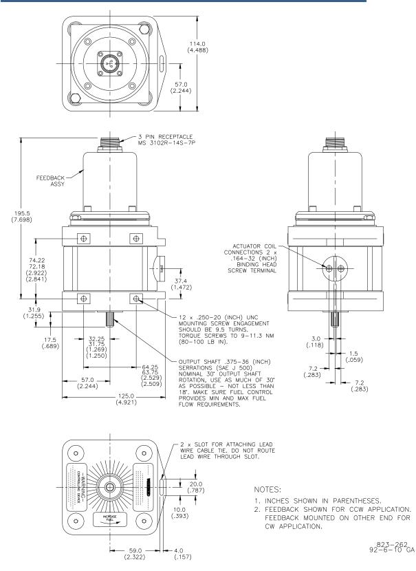
Figure 3-8. 524 Electric Actuator
